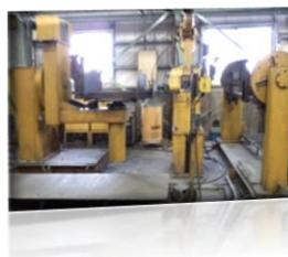
溶接については、溶接ロボットを導入し
